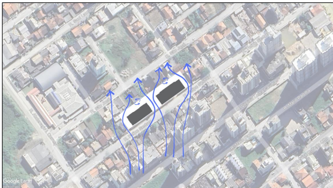
Figura 17: Situação esquemática - Sentido vento sul
