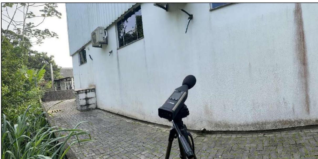
**Figura 10: Detalhe do ponto de medição de NPS 05 do empreendimento.**
