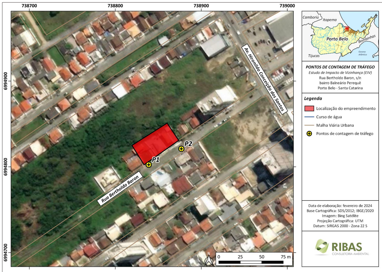
Figura 14- Mapa indicando os pontos de contagem de tráfego. Fonte: RIBAS Consultoria Ambiental, 2024.
