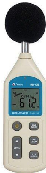
Figura 21- Medidor de ruído digital MSL-1355B, utilizado nas medições.
